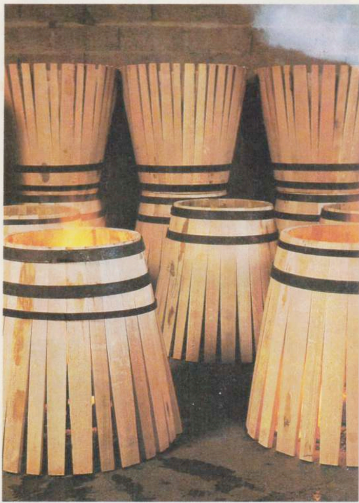
Il fuoco per piegare le doghe. In alto, lavorazione delle "barriques".
